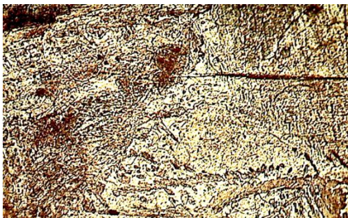
Fig. 9(d) Microstructure of HAZ
