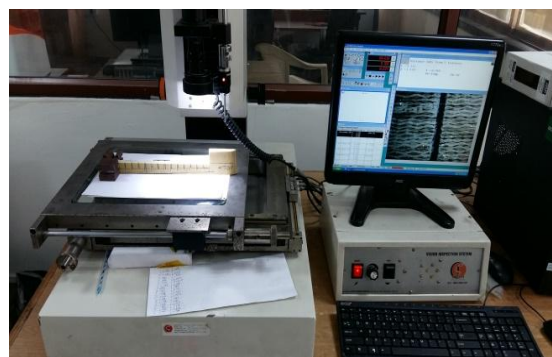
Fig. 4 Vision measurement system (Sipcon SDM-TRZ 5300)
